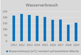
Durch die Optimierung der Waschstraße konnte der Waschmittelverbrauch deutlich gesenkt werden. Der Wasserverbrauch ist durch die Deaktivierung der Pressenwasser-Rückgewinnung gestiegen. Diese Anlage soll aber 2020 wieder aktiviert und getestet werden.
