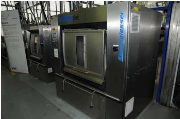
Die neuen Waschschleudermaschinen der Firma Kannegiesser mit optimierten Waschprogrammen und innovativer Spültechnik.
